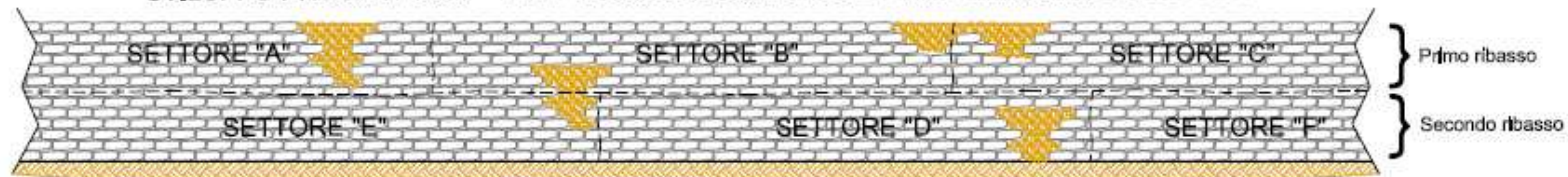
SVILUPPO PROSPETTICO - RAPPRESENTAZIONE SEQUENZA OPERATIVA PER SETTORI
